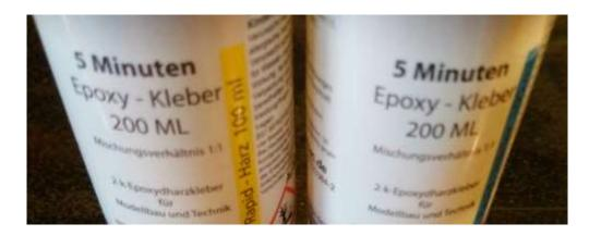
Wie bereits angesprochen verwende ich hierzu den 5min-Epoxyd-Kleber (2K-System). Er bietet genug Zeit um die Teile aus zu richten und ggf. zu korrigieren, andererseits ist die Zeit bis zum Aushärten nicht zu lang, so dass man die Teile nicht unnötig lange halten muss, denn man kann nicht überall mit Hilfsmitteln fixieren!
