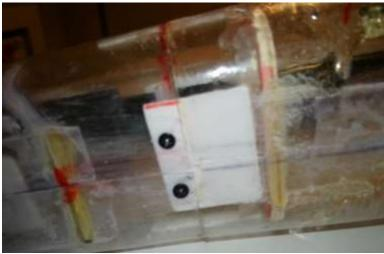
Die Stosskanten, bzw. Ansetzkanten habe ich mit Glasfaser-Füllspachtel abgezogen, dann geschliffen und eine Probelackierung vorgenommen. Leider sieht man jede Riefe sehr deutlich, so dass ich noch einen Füller verwenden werde, den ich dann nass schleife, bevor ich endgültig lackiere.
