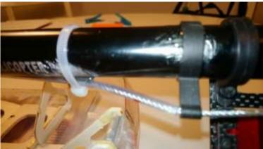
Am Heckrotor wurde ersteinmal alles lose angehalten und vorallem bewegt, um die endgültige Länge und Lage des Zuges zu ersehen. Jede Bewegung oder Kurve beeinflusst die Endlage der Anlenkung und somit auch indirekt schon die Pitch-Verstellung! Ebenso verhält es sich bei wakelndem Zug. Also: fest verkleben!
