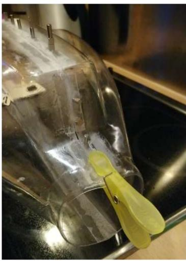
Hier sind die Verbindungsstreifen zu sehen und eingeklebt. Fixiert wird mit Wäscheklammern und Magneten. Die Magneten können verschoben werden und verteilen den Sekundenkleber beim Hin- und Herschieben. Den Sekundenkleber lässt man in die Klebestellen "einlaufen", so dass er danach eingesaugt wird. Hier muss man Schnell und präzise vorgehen. Mit Gel-Sekundenkleber hat etwas mehr Zeit – dieser verteilt sich aber schlechter.
