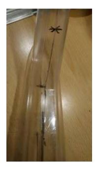
Auf diese Art bekommt man eine schöne, gut passende Schnittkante zum Verkleben des Heckrumpfes. Verklebt wird abermals mit den Resten des groben Zuschnittes und Sekundenkleber. Alle Klebeflächen sind wieder an zu schleifen und mit Aceton/Spiritus zu reinigen.
