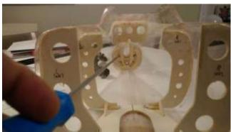
Im Bild rechts zu sehen, wie man mit einem langen, magnetischen Schraubendreher, die Schrauben einführen und auch drehen und festziehen kann. Dies geht auch bequem bei eingebauter Mechanik.
