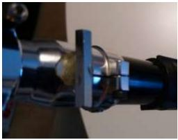
Um die Rumpfhälften gut miteinander zu verbinden und alles auf gleichem Niveau zu haben, habe ich aus 4mm Messingrohr (Innendurchmesser3,1mm) und 3mm Carbonstab eine Führung gebaut. Dazu kommen Neodym-Magnete. Die Rumpfhälften ziehen sich super zusammen und sind perfekt zueinander ausgerichtet.
