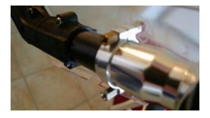
Gegen das Verdrehen der Aufnahme wurde ein Bolzen eingeklebt mit Epoxy. Da das Aufstecken danach aber sehr schwierig war, habe ich diesen wieder entfernt und werde ein Gewinde einschneiden, um eine Schraube bis in das Heckrohr einschrauben und fixieren zu können - vermutlich M5.
