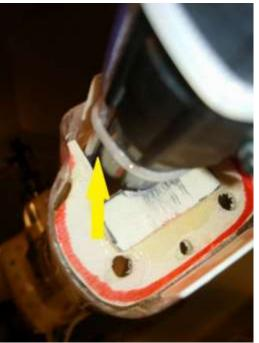
Der Pfeil zeigt, dass sich der Zug am Ausgang des grösseren Heckrumpfes selber gegen Wegdriften fixiert (zwischen Heckrohr und Spant). Der Kabelbinder hält den Zug nur auf dem Niveau des Getriebes und dient nicht zur Befestigung. Alles kann problemlos demontiert (abgezogen) werden um die Mechanik zu zerlegen.
