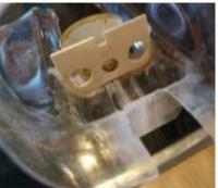
Der Spant, der die Mechanik am Heckgetriebeausgang stützt, fixiert und stabilisiert. Diesen musste ich bei meiner Mechanik allerdings anpassen, da er nicht an die vorgesehene Stelle passte.
