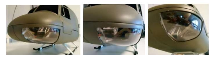
Bei den Oberlichtern das gleiche Schema: anzeichnen, ausschneiden, anhalten, checken, nachlackieren, einkleben.
