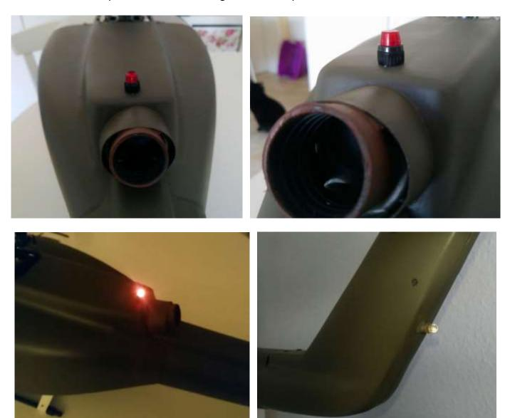
Bereits ein paar Monate vorher hatte ich im Urlaub in Österreich, wo ich täglich fliegen konnte, ein Arduino-Programm (im Anhang) erstellt und mir eine entsprechende Hardware gebaut (Arduino-Nano V3 auf Platine im Alugehäuse). Die weisse(n) Positionsleuchte(n) blinken abwechselnd (2 Stück) und in der Wechselpause gibt die rote Leuchte an der Turbine einen Doppelblitz ab. Vorne ist ein USB-Anschluss um alles (um) zu programmieren.
