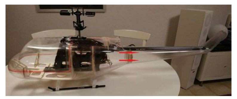
Ebenfalls wegen der Heckhöherlegung muss ich, um alles verschrauben und montieren zu können, den Heckrumpf nochmals trennen. Dafür habe ich mir, unter zuhilfenahme des kleinen Spants, einen weiteren Spant gefräst.
