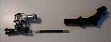
Vorne sieht man den vorher rausgeschraubten Wellenmitnehmer, der dann wieder mit Epoxy eingesetzt wurde. Es kommt noch ein Splint ca. 3-4mm hinter dem Anschlagrand zur Welle hindurch. Ebenfalls mit Epoxy fixiert. Das Ergebnis – die Zusammengebaute Heckhöherlegung mit innenliegender Welle und Heckrotor-Aufnahme. Gleiche Prozedur wird nun noch bei der langen Welle im Heckrohr erforderlich, da auch dieses gekürzt wird.
