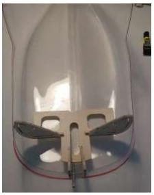
Die verklebten Teile dann im Rumpf einpassen. Immer wieder anhalten, anzeichnen und ausrichten. Die Lage der Spanten zum Rumpf markieren, damit man beim Einkleben sauber arbeiten kann. Wenn man mit 5min-Epoxy-Kleber arbeitet, hat man genügend Zeit, die Teile an den angezeichneten Stellen auszurichten, bevor der Kleber aushärtet. Auch die Mechanik sollte man dazustellen, um zu sehen, ob alles passt.
